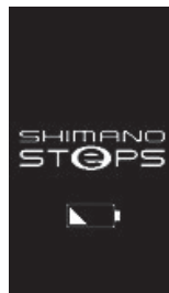
Niveau de la batterie trop faible
